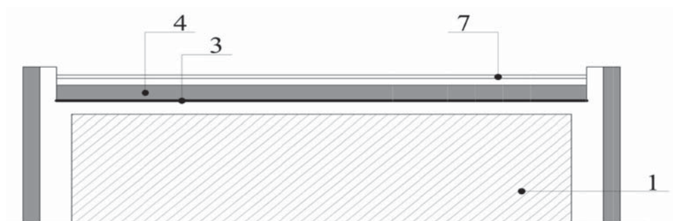
г – утепленная совмещенная плоская крыша
